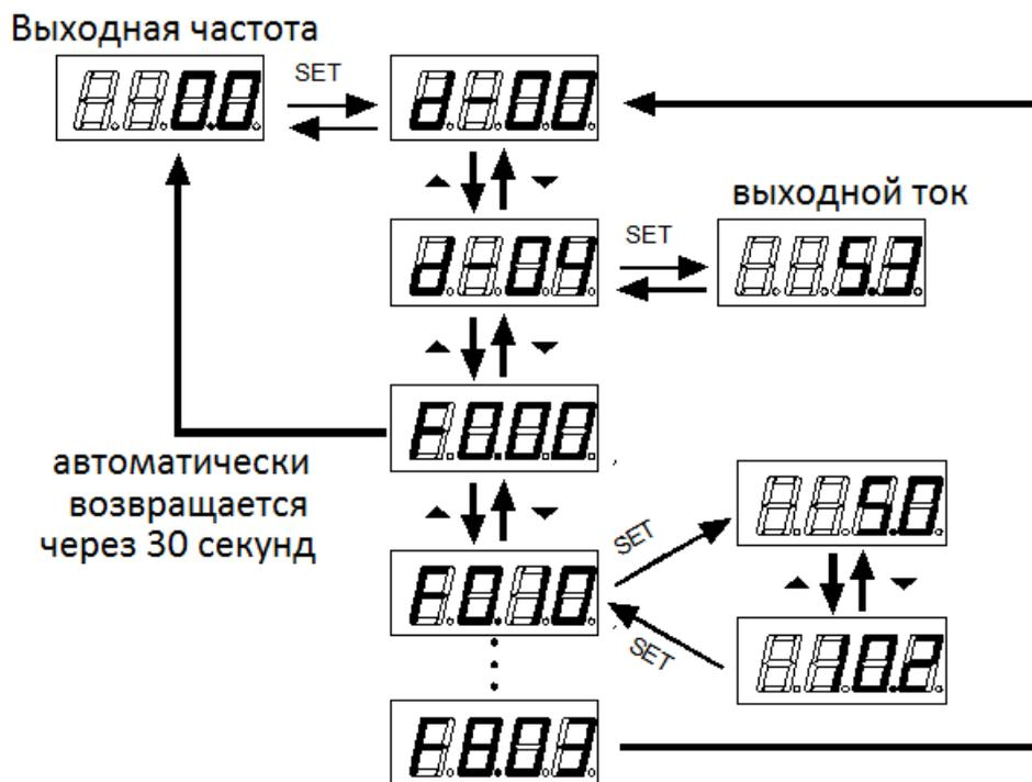
После установки параметра возвращаемся в мониторинг частоты:
