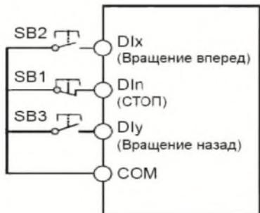
SB1: Кнопка Стоп (замкнутые контакты – пуск разрешен)
